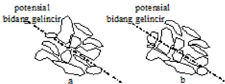
Gambar 3. Susunan struktur tanah tidak mengunci (a) dan mengunci (b) pada potensial bidang gelincir
